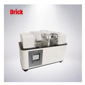
DRK242A-II 抗挠曲损伤试验仪,用于涂层织物动态抗扭曲弯挠疲劳性能的测试。
