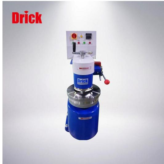
DRK11-L PFI 磨浆机(又名扣解机或立式打浆机)是用于在制浆造纸实验中,为纸浆的扣解度的测定、纸浆试样水分的测定、纸浆浓度的测定、湿解离度的测定,游离度的测定提供标准的定量试样,PL11型磨浆机依据 ISO 5264/2-1979《纸浆实验室打浆——第二部分: PFI 磨法》以及 ISO5264/2、TAPPIT248 所规定的实验标准设计。
