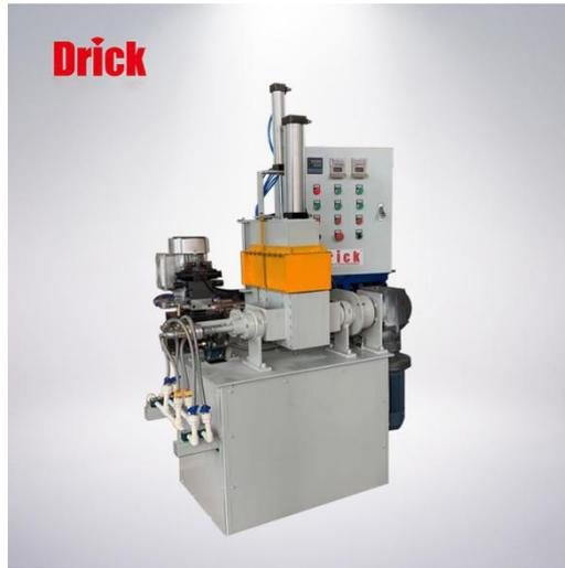
ML 密炼机(1L), 本产品满足 GB/T6038-2006《橡胶试验胶料 配料、混炼和硫化设备及操作程序》试验标准要求。
